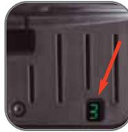
Die Digitalanzeige für die Einstellung der Parameter befindet sich unter der Wartungsklappe.
