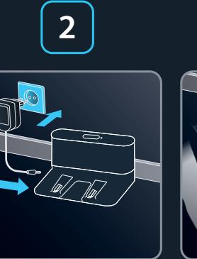
**ES** Conecta la base de carga. Retira la cinta protectora del parachoques del robot para garantizar el buen funcionamiento del mismo.
