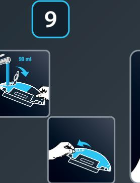
**ES** Abre el depósito de agua del accesorio para la mopa y llénalo con 90ml de agua. Cierra el depósito de agua.
