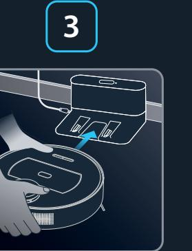
**ES** Coloca el robot en su base de carga. Los botones se encenderán con una luz blanca y el indicador de la base de carga se apagará.
